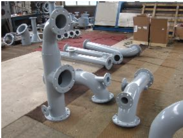
gecoat leidingwerk voor de installatie 1
